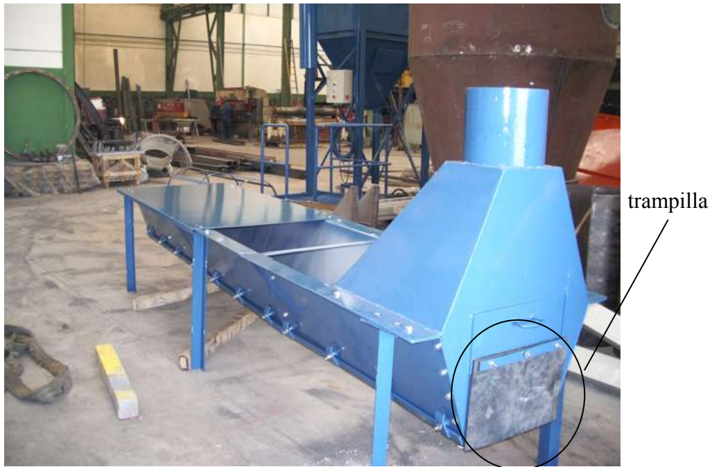
Figura 5 Conjunto de cierre y campana en construcción
