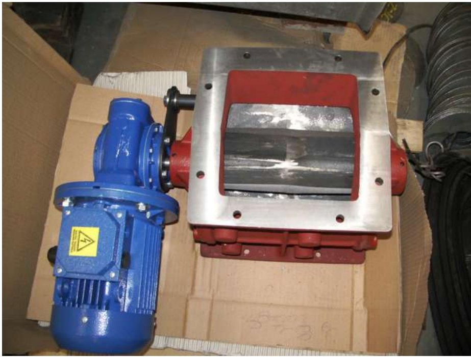
Válvula de paletas sustituida
