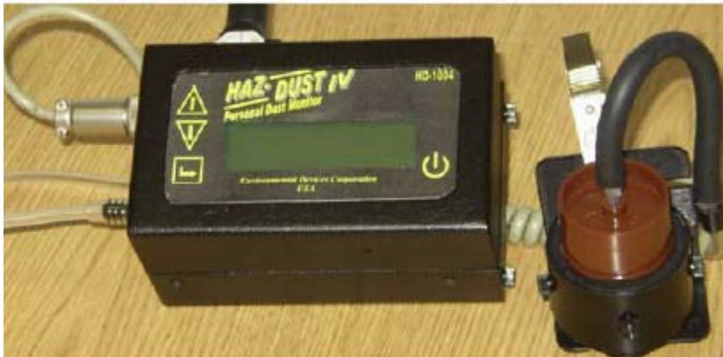
Figura 4 Medidor en continuo HAZ DUST IV
