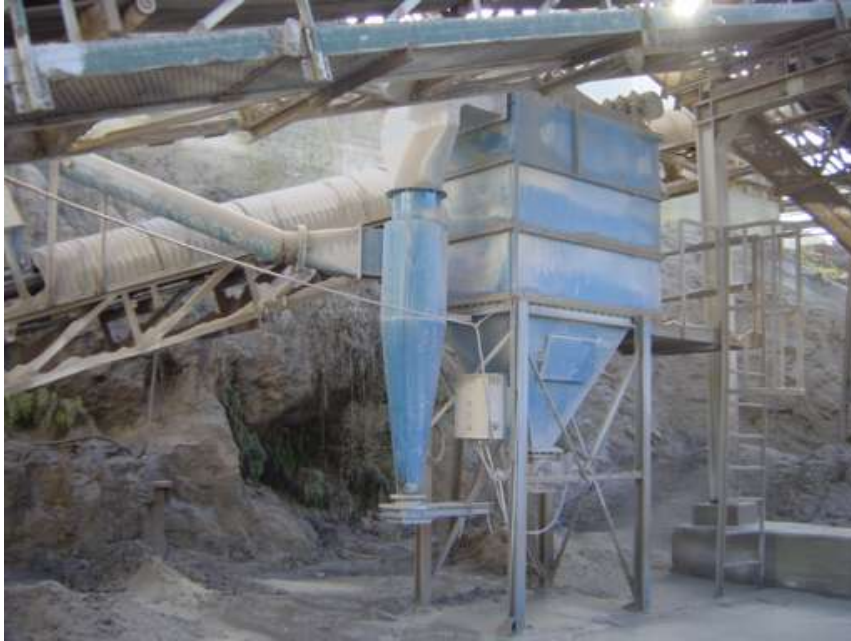
Figura 10 Ciclón y filtro conectados a la campana
