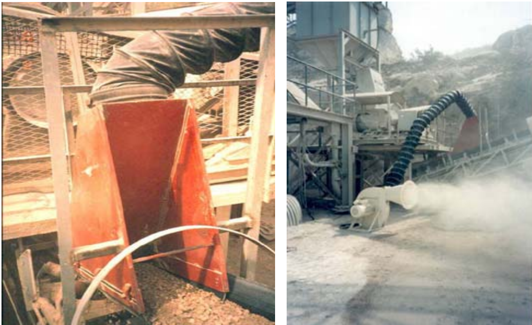
Figura 4 Prueba inicial realizada con campana prototipo
