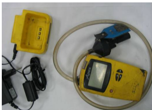
Figura 1 Aparatos de toma de muestras: APEX standard
