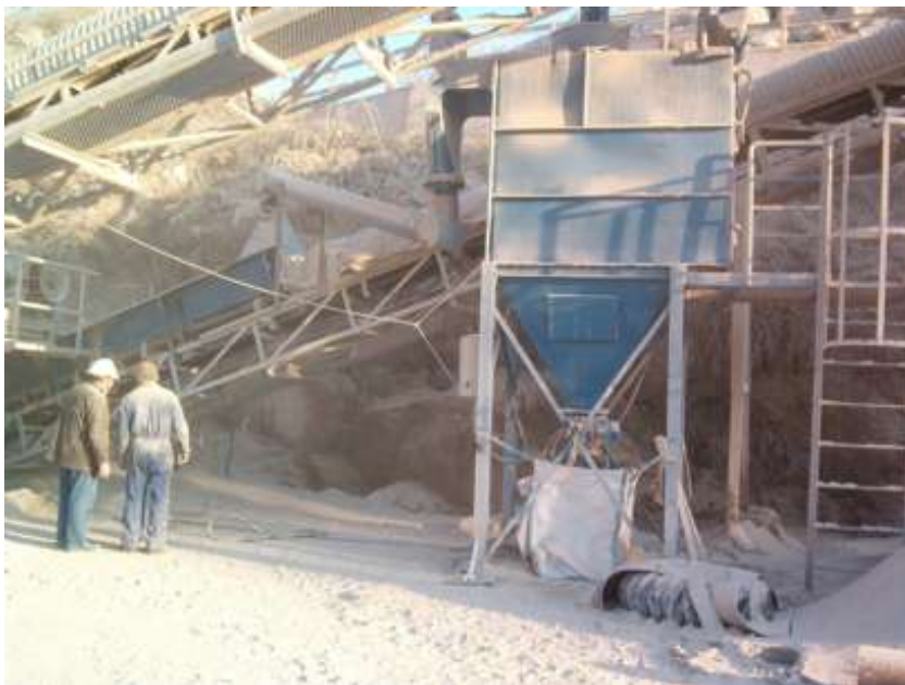
Figura 13 Prueba del filtro de mangas sin ciclón
