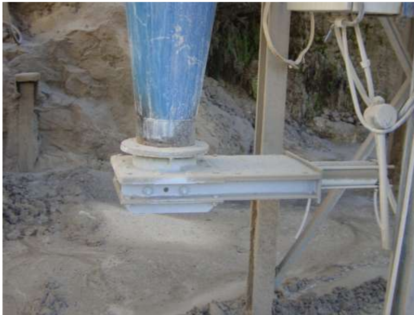
Figura 12 Válvula de guillotina
