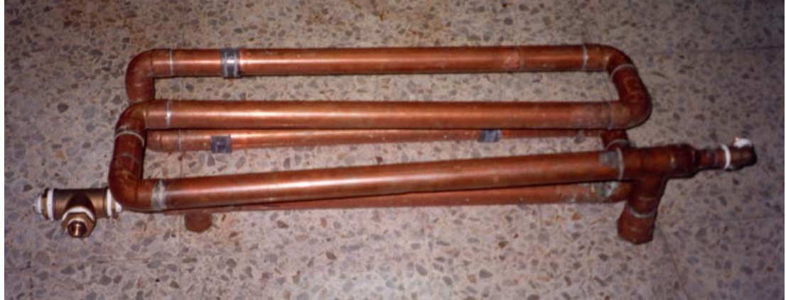
Figura 7.- Intercambiador de calor
