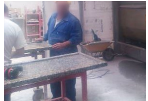
Fig. La rutina de trabajo, incluida posición del trabajador respecto a la medida de prevención (como es la aspiración), puede comprometer o anular la eficacia del sistema instalado.
