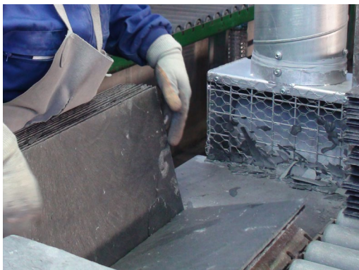
Fig. La captación localizada de polvo es, en general, más problemática que la aplicación de agua. En todo caso, cuando está adecuadamente diseñada puede dar buenos resultados. Es fundamental la formación de los trabajadores al respecto, para evitar que se introduzcan elementos en su radio de acción que invaliden su eficacia, y para que realicen las tareas en la zona de influencia de la misma.
