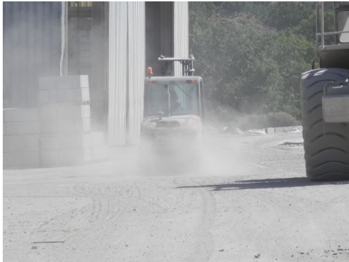
Fig. Puesta en suspensión del polvo por el tráfico en accesos a nave no humectados. Además del riego de pistas, es fundamental contar con sistemas que eviten la entrada de polvo en las naves como consecuencia del tráfico del entorno y corrientes de aire dependientes de factores climatológicos.
