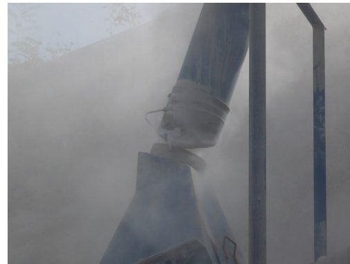
Fig. Fallo de mantenimiento en punto de trasvase. Se insiste en la Guía en la importancia de contar con un plan de mantenimiento específico para medidas de prevención.
