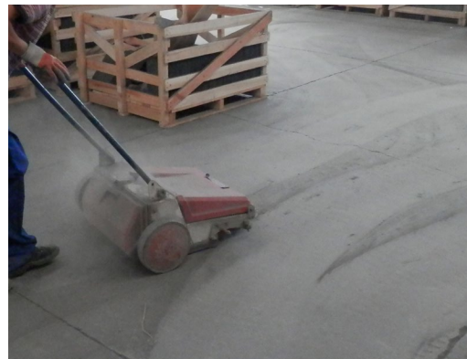
Fig. La limpieza debe realizarse por métodos húmedos preferiblemente, y aspiración. Los medios mecánicos tradicionales contribuyen a poner polvo en suspensión, y deben sustituirse por los primeros.
