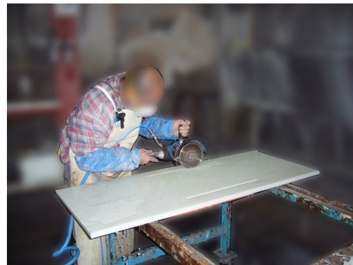
Fig. Puesta en suspensión de polvo por uso de herramienta manual sin medida de prevención (izquierda) o con aplicación de agua (derecha).
