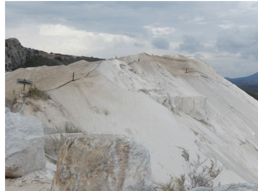
Fig. Humectación de materia prima previa a la carga y para evitar arrastre por el viento.
