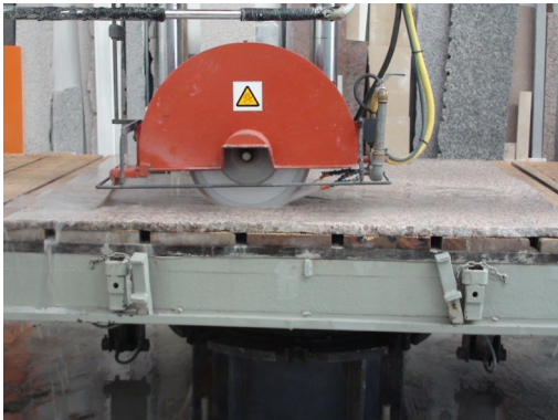
Fig. Las boquillas han de orientarse adecuadamente sobre el foco de emisión de polvo para que resulten eficaces. En ocasiones se aplican únicamente sobre el útil de corte, con lo que habría que reorientarlas o añadir alguna específicamente aplicada.
