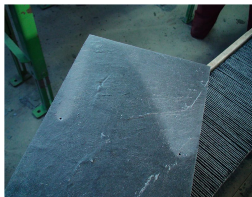
Fig. Ejemplo de captación para taladradora bien configurada, cuya capacidad de arrastre de polvo queda reflejada en la laja perforada.
