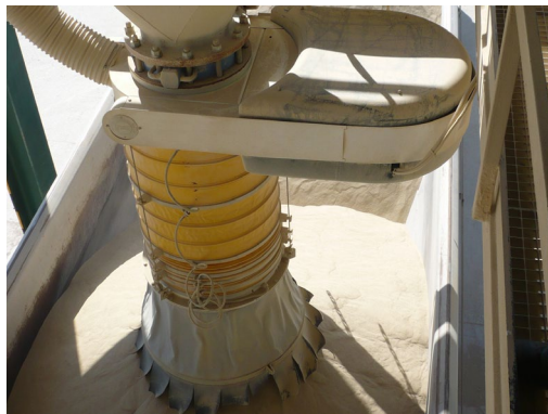
Fig. Descarga desde tolva a camión con manguera telescópica, que se optimiza contando con un plan de mantenimiento específico y una sistemática de respuesta inmediata en caso de producirse un fallo.
