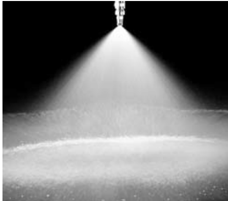
Figs. La capacidad de arrastre de la partícula de polvo en la nebulización dependerá del tamaño de gota, de ahí la importancia de seleccionar adecuadamente la boquilla.
