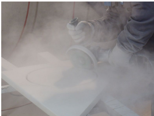
Fig. Puesta en suspensión de polvo por uso de herramienta manual sin medida de prevención (izquierda) o con aplicación de agua (derecha).
