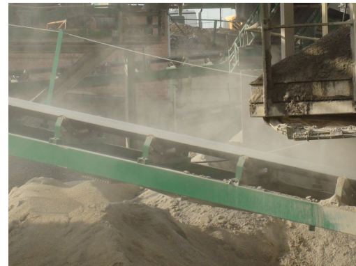
Fig. Cinta sin capotaje, ni humectación del material, y acumulación de polvo por falta de plan de limpieza.
