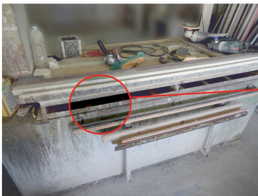
Fig. Ausencia de filtros, lo cual invalida absolutamente la eficacia del sistema.
