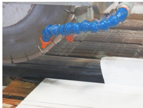
Fig. Un desajuste de milímetros en la orientación de la boquilla sobre el punto de corte y emisión de polvo puede reducir de manera decisiva su eficacia.
