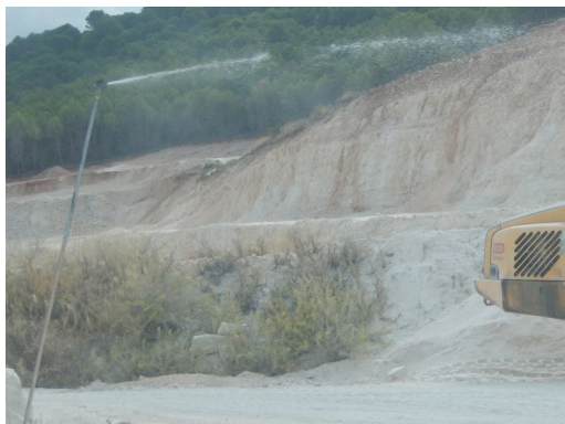
Fig. Es fundamental el riego de pistas para evitar la puesta en suspensión de polvo.
